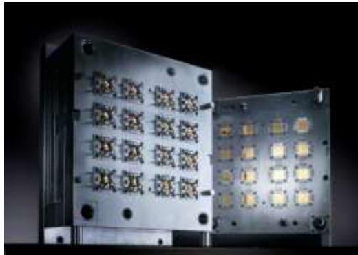
16-fach Form für optischer Linsen zur Solarstromerzeugung
